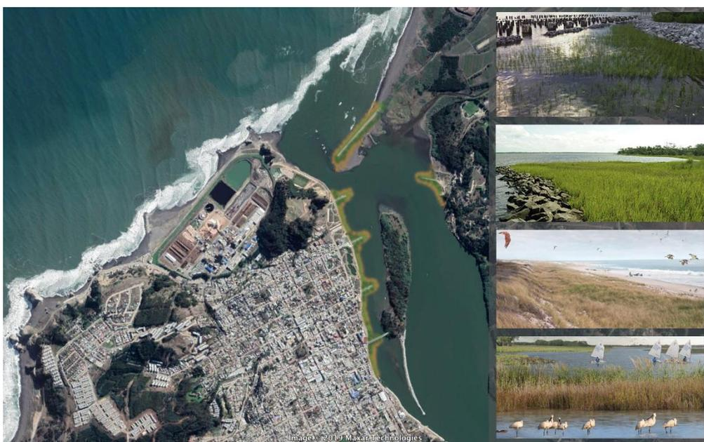
Fig. 42. Imagen Objetivo de las estrategias off-shore aplicadas al caso del Parque de Mitigación de Constitución, a través de espigones perpendiculares a la ribera para promover captura de sedimentación proveniente del río, generando bancos de amortiguación a través de la acumulación progresiva de suelo para establecimiento de vegetación riparia. Las estructuras de captura, sostenidas mediante taludes de
