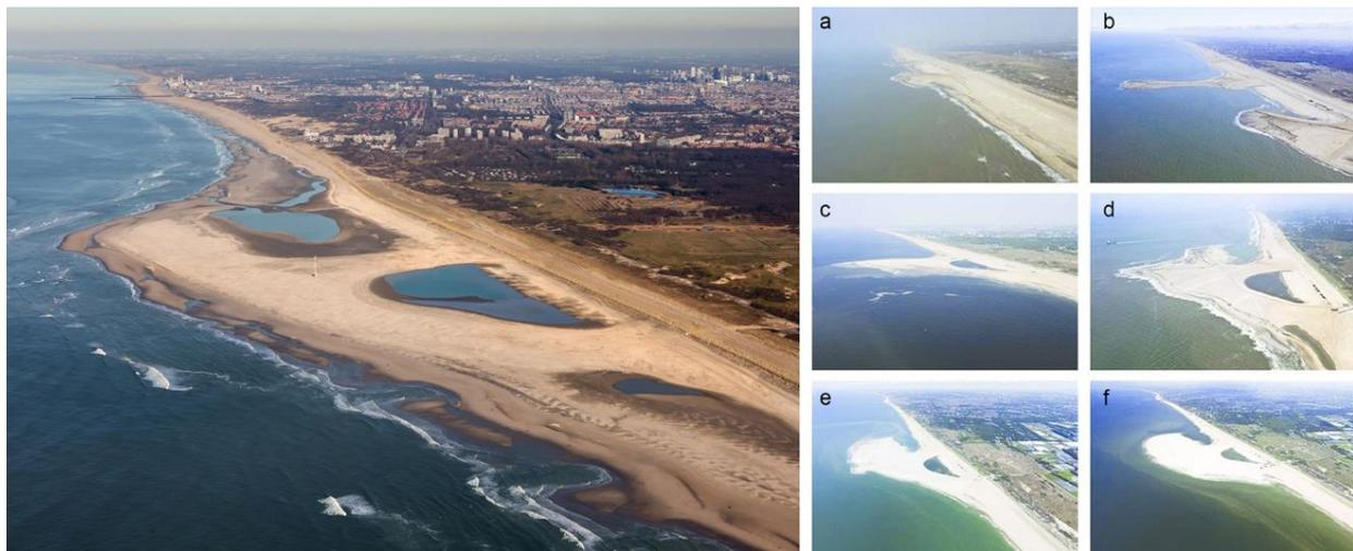
Fig. 7. The Sand Engine, provincia de Zuid Holland. El diseño de la duna expandida en forma de península va modelándose mediante la acción de mareas y vientos, para progresivamente extenderse a lo largo de la costa como buffer de protección ante tormentas y alza del nivel del mar. En la secuencia de fotografías aéreas se observa el proceso de construcción durante: a) 15 de Marzo, 2011; b) 25 de Marzo, 2011; c) 25 de Abril, 2011; d) 17 de Mayo, 2011; e) 14 de Junio, 2011; f) 11 de Julio, 2011.
