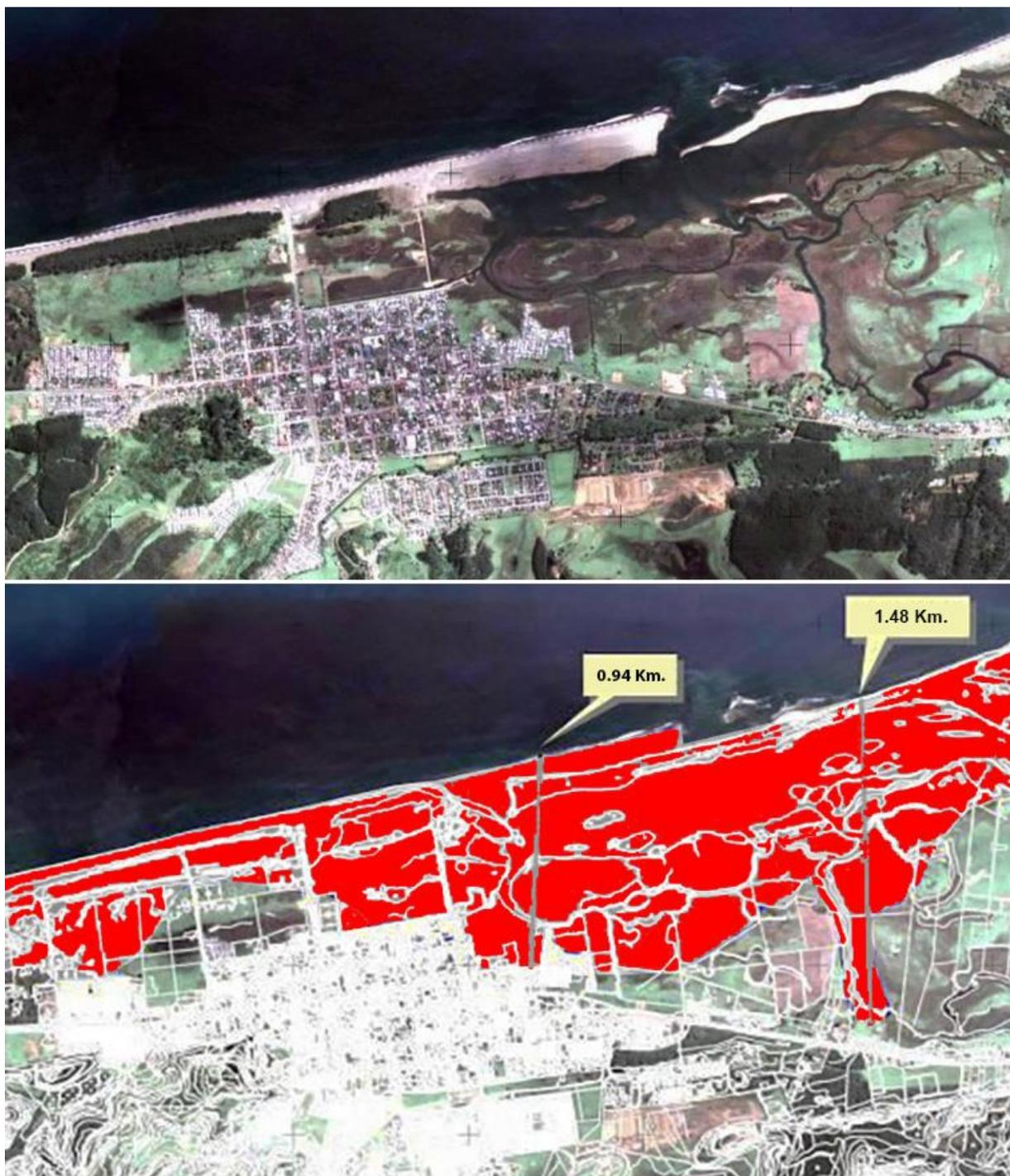
Fig. 16. Carta de inundación modelada en la localidad de Arauco, región de Biobío. Se observa el rol de los humedales costeros y el cordón dunario como infraestructura de amortiguación de los efectos de inundación en el Tsunami del 27F. Arriba, Imagen satelital de la localidad de Arauco. Abajo, Plano con área de inundación del tsunami del 27F en la localidad de Arauco. Fuente: Belmonte et al. (2011).
