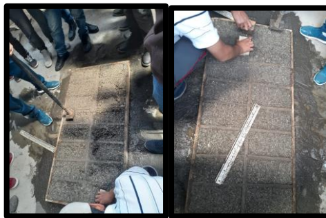
Figura 5. Compactación de bloques
