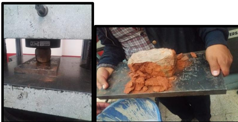
Figura 9: Compresión de ladrillo comercial
