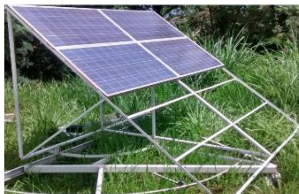
Figura 3. A partir dessa figura é possível verificar o posicionamento da estrutura utilizada para os ensaios experimentais com inclinação do sistema de 35° e um grau de liberdade, que é a condição inicial do sistema (posição fixa).
