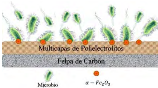
Figura 2. Mecanismo de transferencia de electrones de las bacterias al ánodo al utilizar polielectrolitos/ \alpha\text{-Fe}_2\text{O}_3 (Meicong, Zinuo, Fei, Liping, & Xuejun, 2020)
