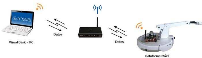
Figura 6. Comunicación inalámbrica modo Infraestructura
