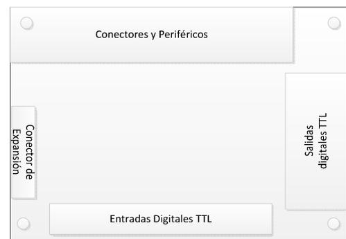
Fig. 4. División de la tarjeta de expansión
