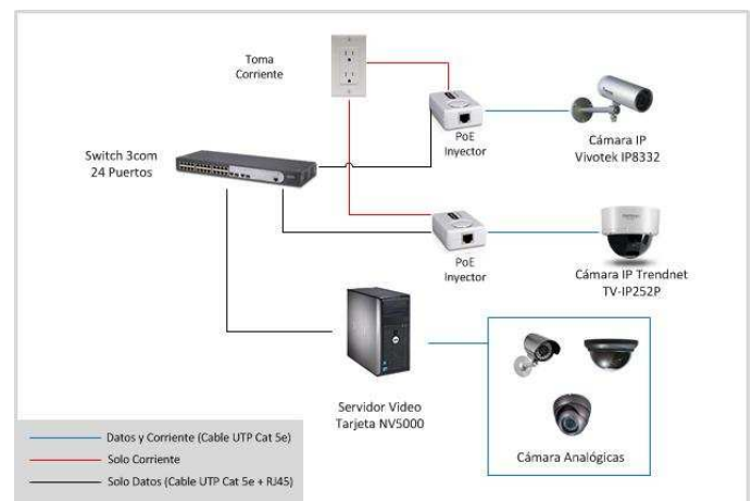
Figura 11. Diagrama de Red Sistema CCTV
