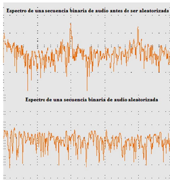
Fig. 1. Espectro de frecuencia de la secuencia binaria de audio antes y después de ser aleatorizada.
