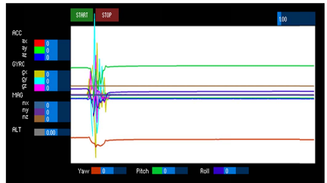
Fig. 8. Datos de sensores con filtro AHRS de Sebastián Madgwick.
