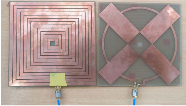
Fig. 11. Antenas impresas en el sustrato FR4
