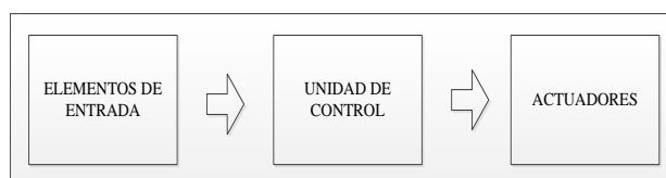
Ilustración 1: Estructura de un sistema automatizado.
