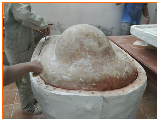
Figura 4b. Fabricadas las piezas del molde, se procede a desmontarlas para extraer el modelo interno
