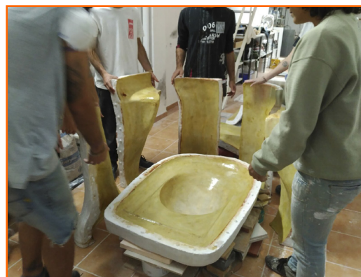
Figura 4c. Molde de 7 piezas limpio y con desmoldeante en la zona que será la superficie en contacto con el material definitivo
