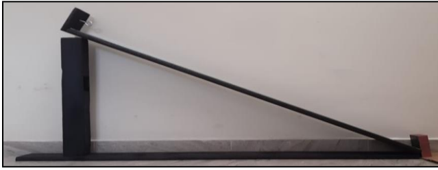
FIGURA 1. Plano inclinado hecho de tabloncillos de madera, pintada de negro.
