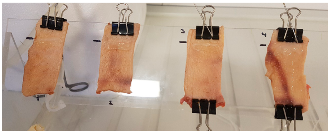
Fig. 2. Montaje del ensayo de mucoadhesividad en plano inclinado
