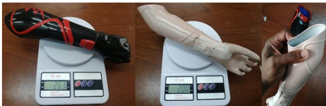
Figura 5. Comparación de peso en gramos de la prótesis impresa en filamento PLA y filamento FLEXIBLE.
