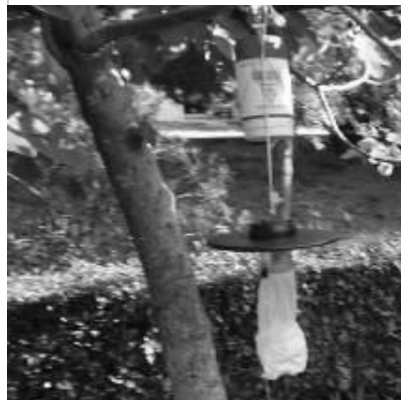
Figura 3: Trampa CDC con luz ultravioleta en un parque de la ciudad de Badajoz.
