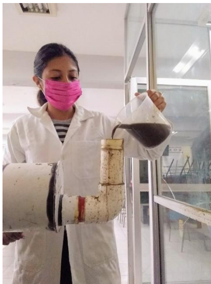
Figura 7. Alimentación de biodigestor semicontinuo
