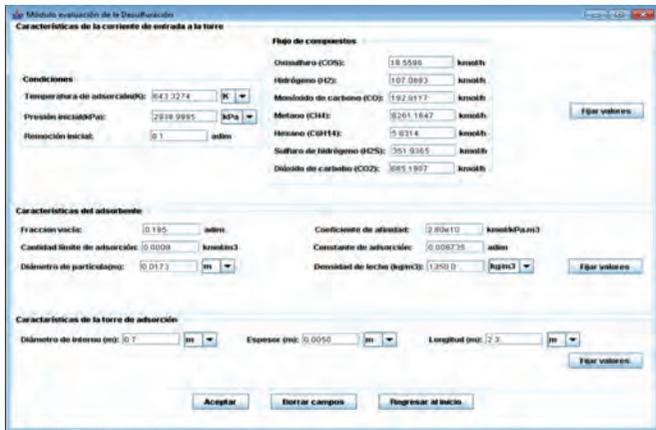
Fig. 5. Interfaz gráfica de introducción de datos, en modo evaluación, para la etapa de desulfuración.
