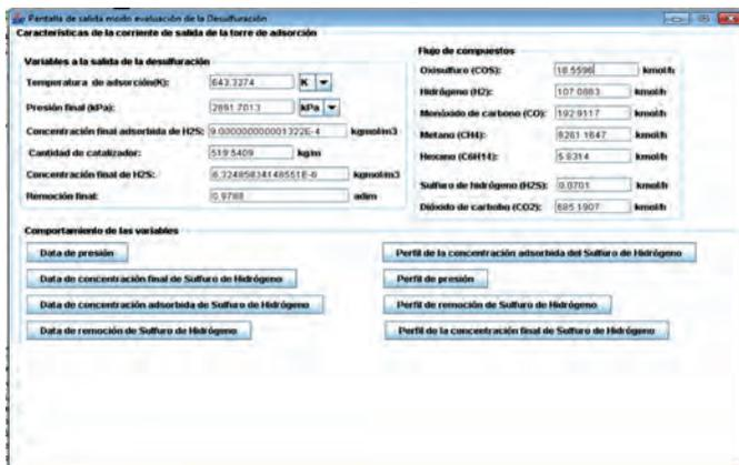
Fig. 6. Interfaz gráfica de resultados de salida, en modo evaluación, de la desulfuración.
