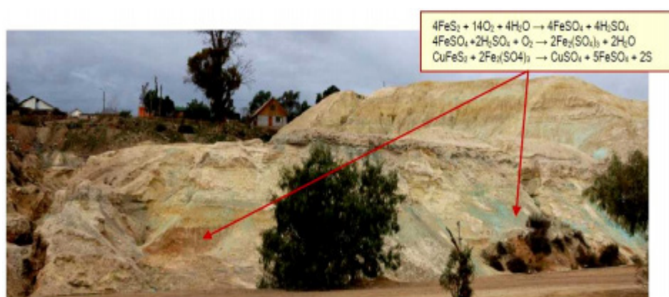
Figura 1: Balsa (relave) en Andacollo, donde se observa acúmulo de minerales oxidados y oxidación de hierro
