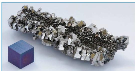
Figura 1. Cristales de niobio de alta pureza (99,995 %) formados por electrolisis, al lado de un cubo de 1 cm<sup>3</sup> de alta pureza (99,995 %) de niobio anodizado (<https://bit.ly/2t05AL4>, visitada el 04/03/2019)
