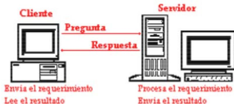
Fig. 3: Modelo Cliente/Servidor(MÁRQUEZ and ZULAICA 2004).
