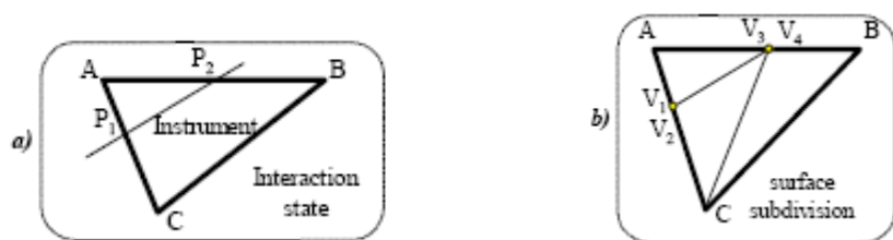
Fig. 8: Modificación de la malla estado intermedio.
