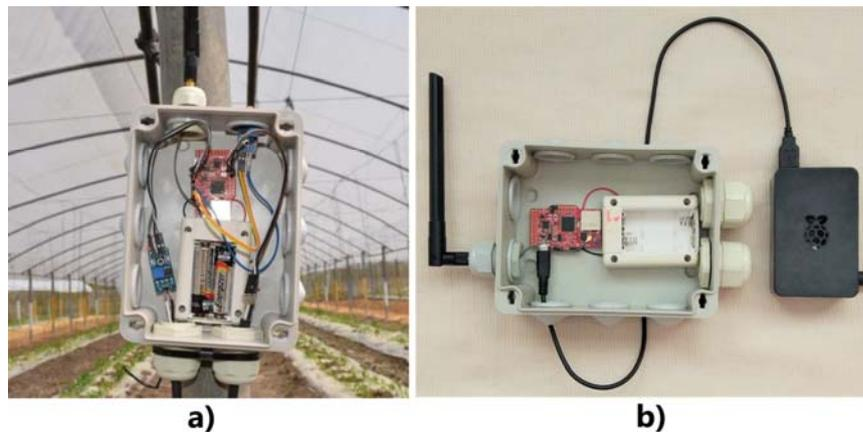
Figura 3. Nodo sensor (a) y nodo enrutador de frontera conectado a la Raspberry Pi (b).
