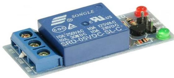
**Figura 7:** Módulo relé para Arduino
