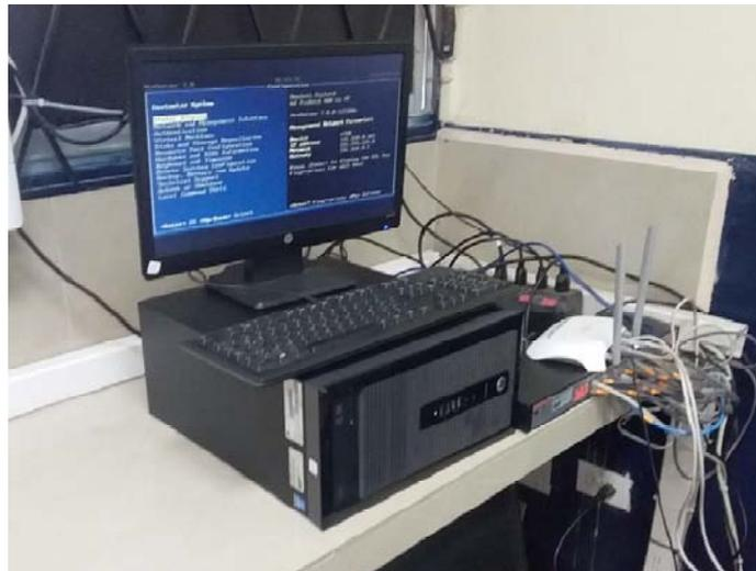
**Figura 5.** Ejecución de Citrix XenServer en el Servidor físico. Fuente: elaboración propia.
