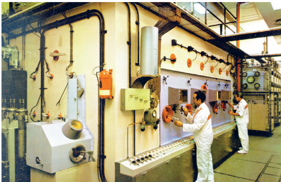
Figura 3. Celda de 1.000 curios dotada de grueso blindaje para manipulación de combustible irradiado en la Planta Caliente M-1. De todas las actividades del ciclo de combustible, la reelaboración es la que posee más riesgos y ha de contar con mayores medidas de seguridad. (Foto: JEN/CIEMAT)
