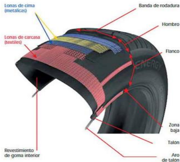
Figura 1: Partes principales del neumático
