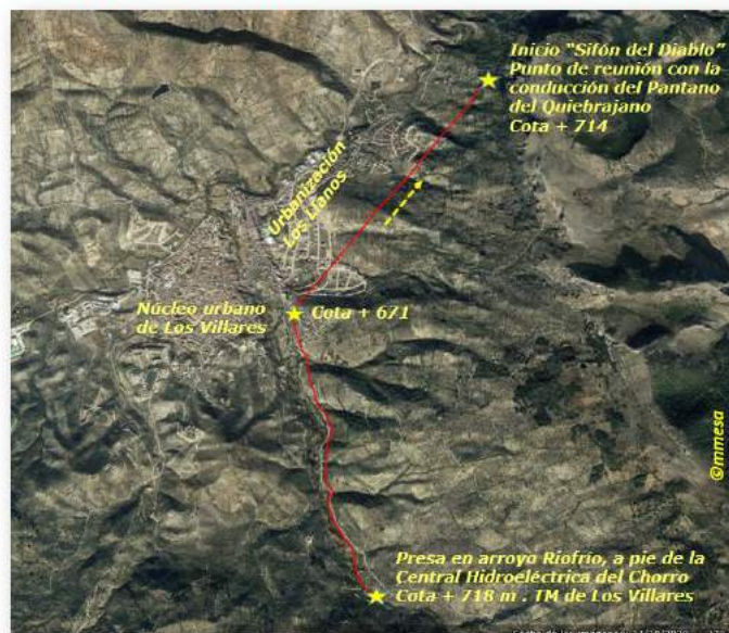
1º Tramo conducción aguas desde Los Villares a Jaén: Presa a pie de la central hidroeléctrica a inicio del "Sifón del Diablo"
