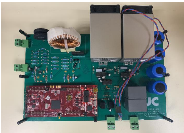
Fig. 9. Montaje final de prototipo del convertidor, incluyendo la tarjetas de evaluación LAUNCHXL-F28379D.
