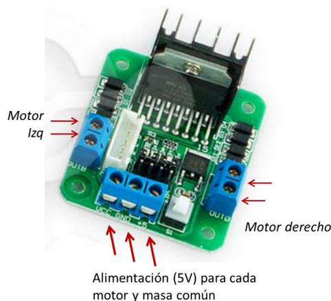
Fig. 2. Placa controladores motores L298 (parte inferior vehículo)
