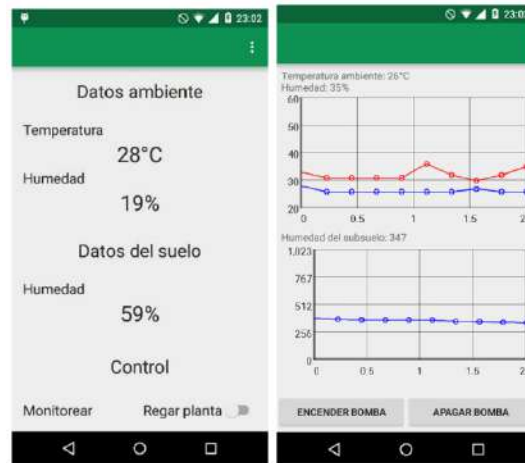
Figura 8. Interfaz de usuario para el monitoreo de la humedad del suelo temperatura y humedad del ambiente.
