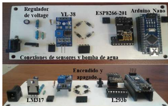
Figura 3. Fotografías tomadas del dispositivo electrónico sin pantalla LCD.
