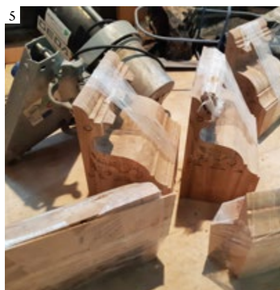
4: Joist repair (oak). 5: Replacement corbels. 6: Restored corbel | 4: Reparación de vigas (roble). 5: Ménsulas nuevas. 6: Ménsula restaurada | 4: Reparação das vigas (de carvalho). 5: Mísulas de substituição. 6: Mísula restaurada
