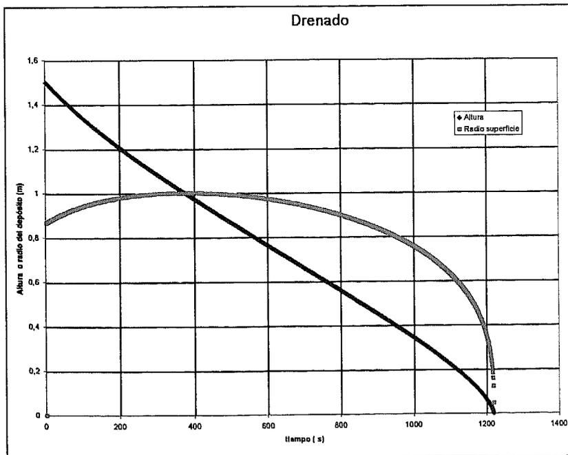
Figura 3. Variación de la altura y del radio instantáneo frente al tiempo
