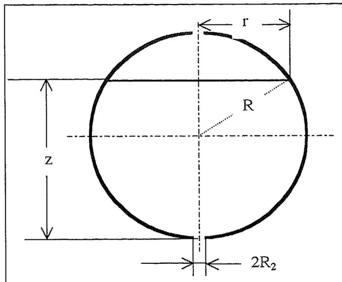
Figura 1. Esquema del depósito y sus variables geométricas
