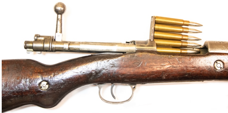
Figura 9. Mostra de la càrrega d'una pinta de cartutxos en un fusell Màuser txec
