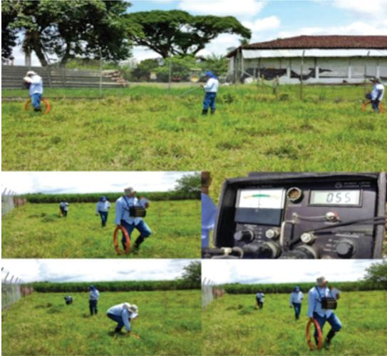
**Figura 6.** Medición electromagnética en la zona de estudio.
