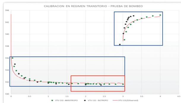
**Figura 12.** Calibración de la prueba de bombeo, Los puntos negros corresponden al medio Isótropo y los puntos verdes al medio Anisótropo.
