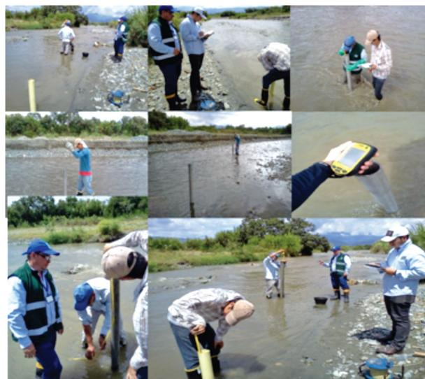
**Figura 5** Estimación de la conductividad hidráulica saturada del lecho del río Tuluá.
