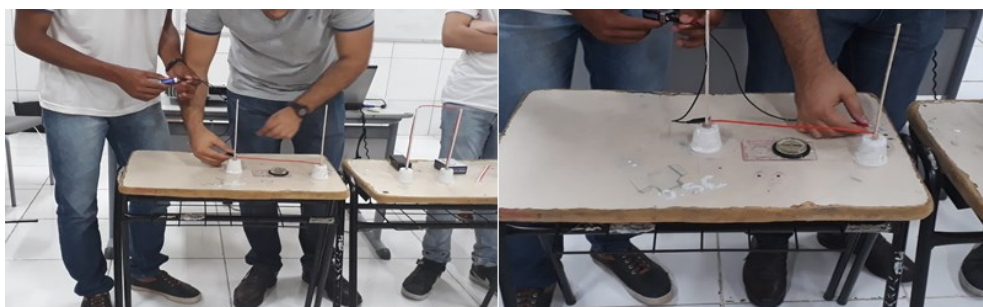
Fig. 4 – Reprodução com materiais de baixo custo dos procedimentos e observações de Oersted. Fonte: Araújo (2020).
