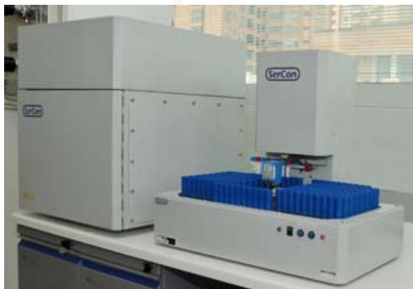
Figura 2. Modelo de espectrómetro de masas de relación isotópica tipo Sercom®, en donde se identifica a la izquierda, el espectrómetro, y a la derecha, la bandeja de muestreo automático. Laboratorio Clínico Hematológico S.A., Medellín, Colombia.
