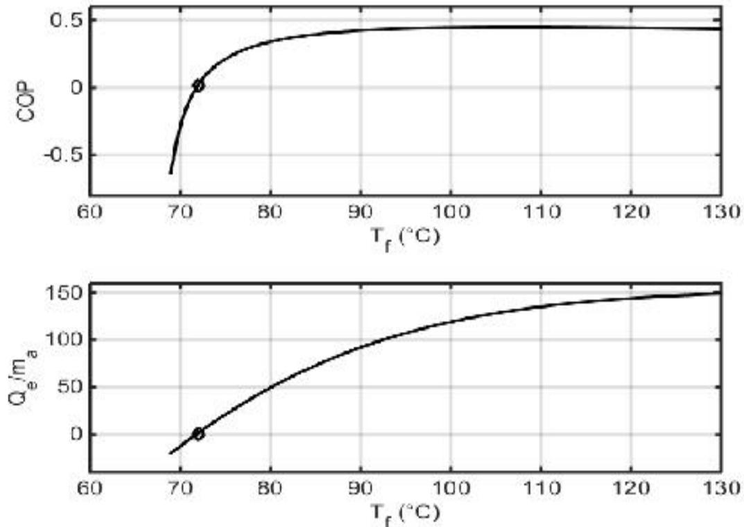
Figura 2, COP // Calor útil de enfriamiento Vs. Temperatura máxima del ciclo.
