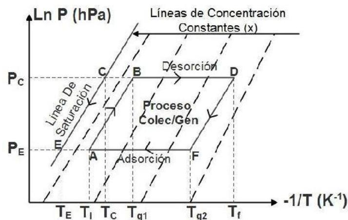
Figura 1 Diagrama (P-x-T) de Clapeyron del ciclo ideal de adsorción
