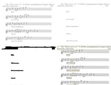
Figura 5. Detección de texto. Arriba-izquierda: imagen original; arriba-derecha: imagen sin pentagramas; abajo-izquierda: imagen sin pentagramas tras aplicar una dilatación horizontal; abajo-derecha: bloques de texto detectados.
