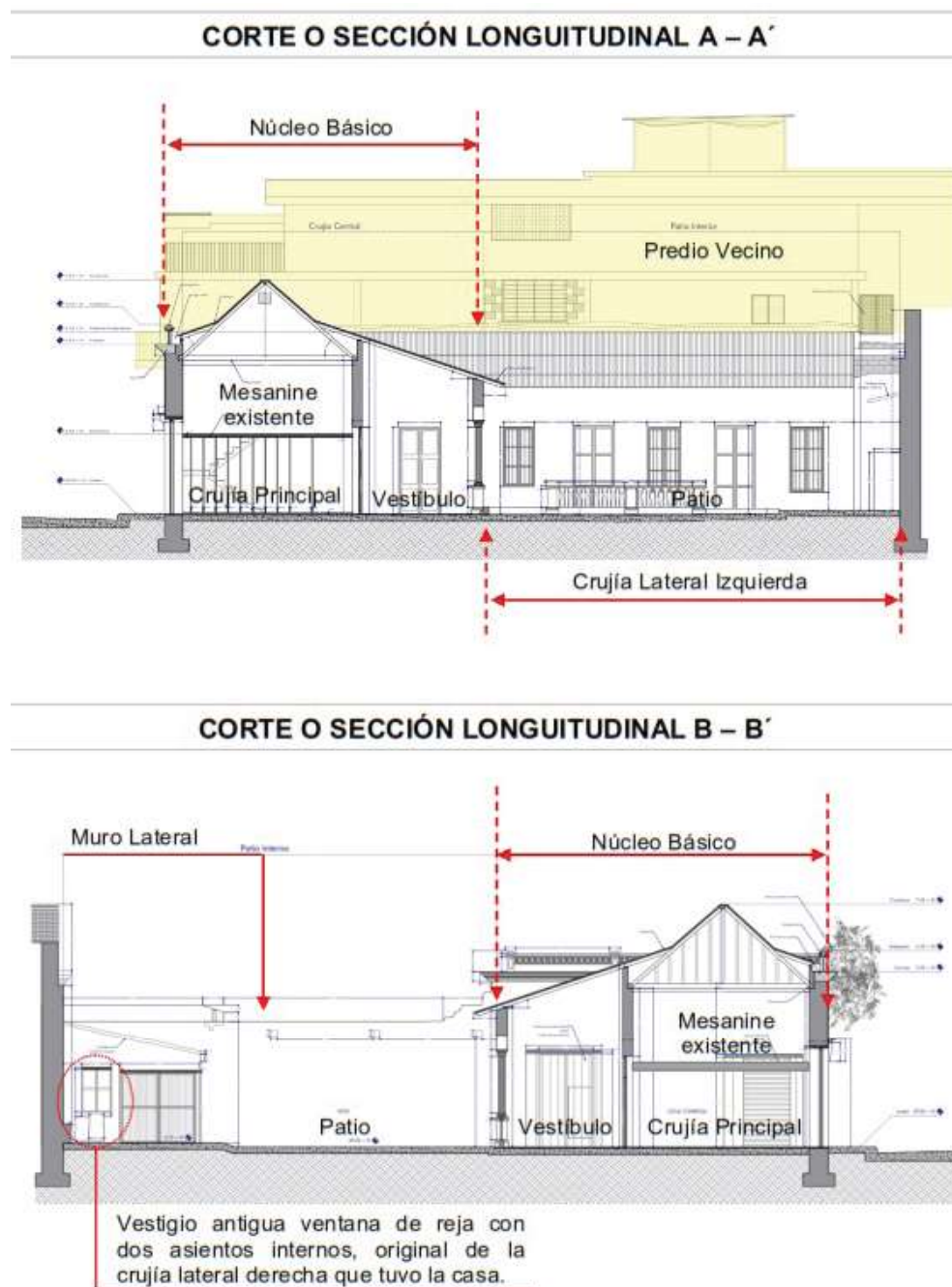
Figura 5. Cortes longitudinal y transversal casa “Landinez”. Fuente: Levantamiento arquitectónico casa “Landinez”, elaboración propia y Andrés Felipe Mendoza.
