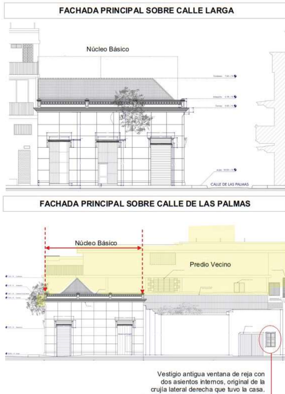
Figura 4. Levantamiento arquitectónico fachada principal sobre la calle Larga y Fachada lateral sobre Calle Las Palmas, casa “Landinez”. Fuente: Levantamiento arquitectónico. Elaboración propia y Andrés Felipe Mendoza.
