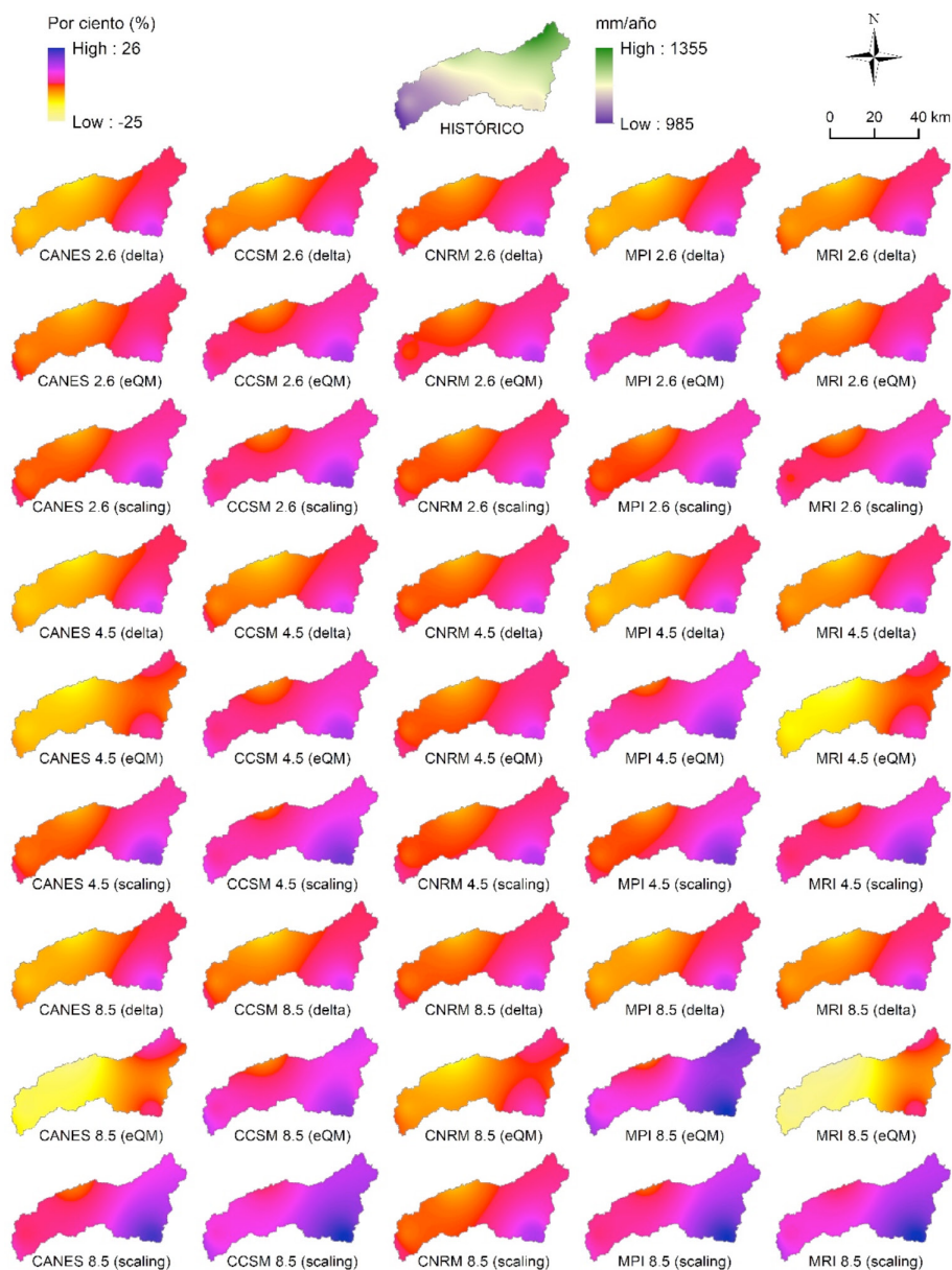
Figura 6. Distribución espacial de la variación porcentual anual de evapotranspiración de referencia (ET 0 ) proyectada para fines del siglo XXI respecto de la histórica (1950-2018) para 45 escenarios de cambio climático. eQM: distribution mapping.
