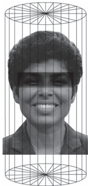
Figura 1. El haz cónico logra la imagen completa con una sola rotación del equipo.
