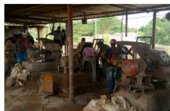
3. Molienda y trituración del material aurífero
