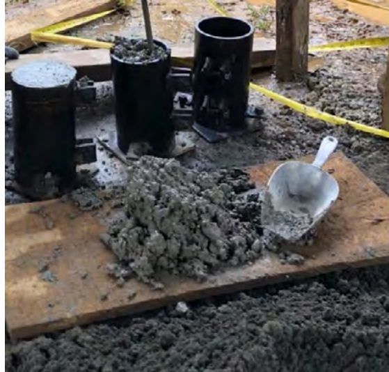
Figura 2. Preparación de los especímenes de hormigón
