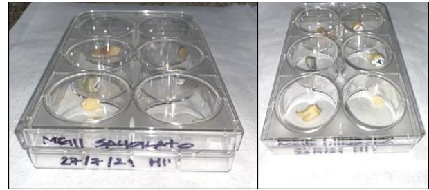
Figura 6. Especímenes sumergidos en medios de Clarificación (Metil/Salicilato y Aceite de inmersión sintético) (Izq.) Estereomicroscopio (Der.).
