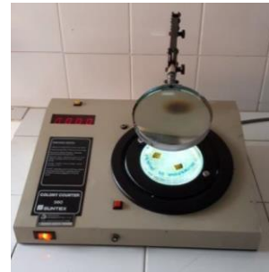
Figura 3. Observación de halos de inhibición con el contador de colonias. Fuente: Propia.
