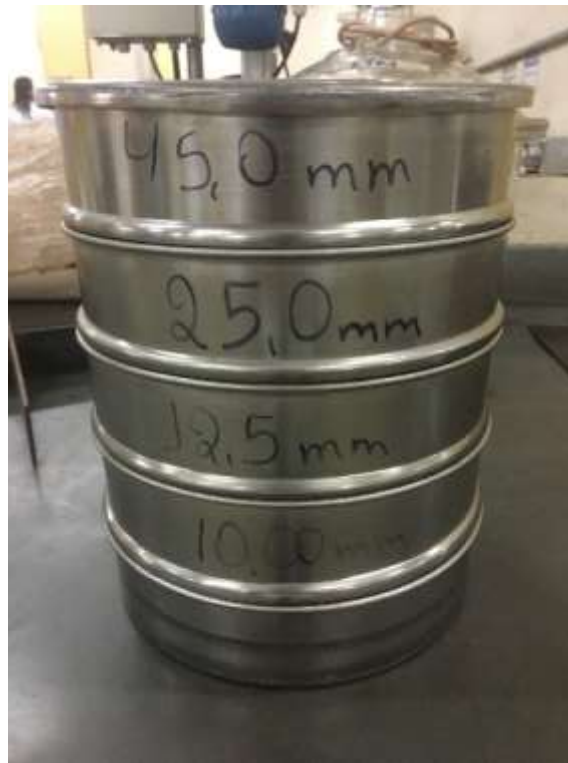
Figura 5 - Série de peneiras utilizadas para classificar primariamente o material
