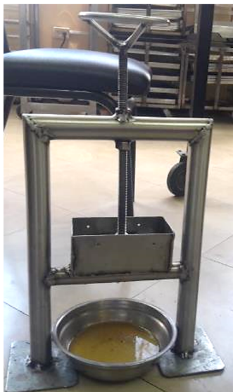
Figura 1. Extractora de aceite por prensado manual
