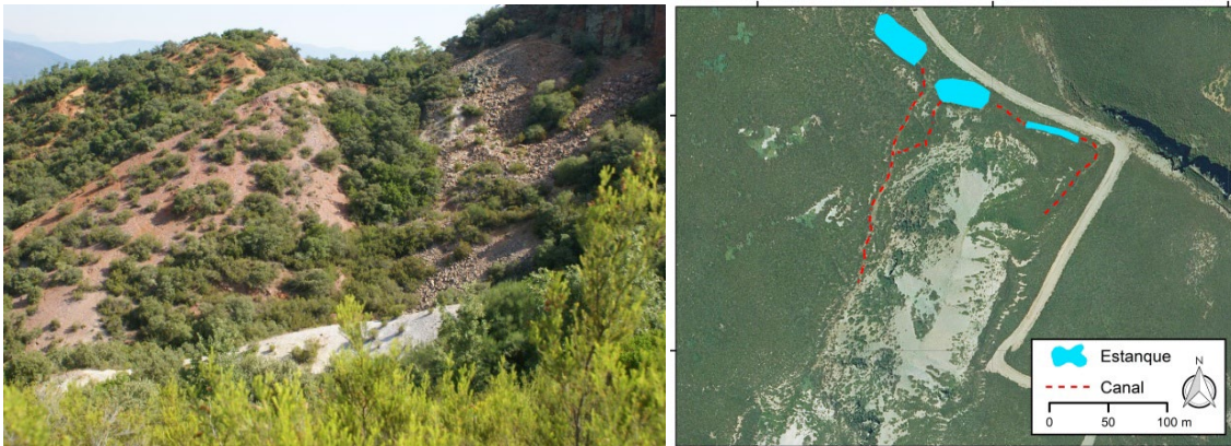
Figura 6. a) Escombreras al pie de una mina primaria en Castropodame, León. b) Ortofoto de una mina primaria de Recunquiños (Burbia, León) con su infraestructura hidráulica de estanques y canales.
