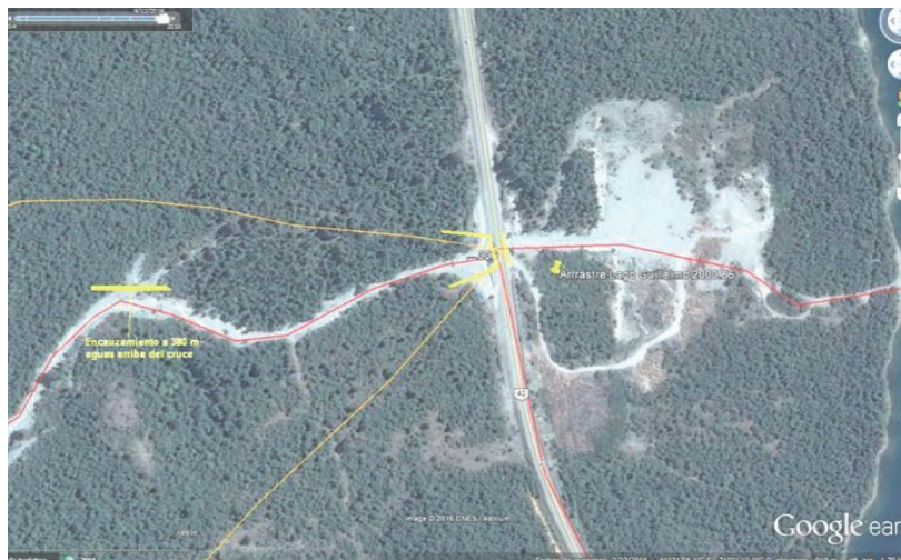
Figura 11. Planta del cruce en progresiva 2000,86. Se observa un nuevo cauce de bajada que se insinúa ladera arriba y la ubicación del espaldón de defensa propuesto para evitar que descendan caudales por el sitio aludido
