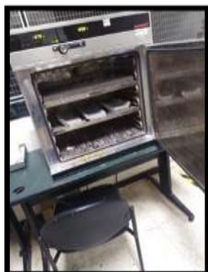
Ilustración 4: Ensayo de absorción en teja 3 Fuente: Propia Elaborado: Karen Lozano
