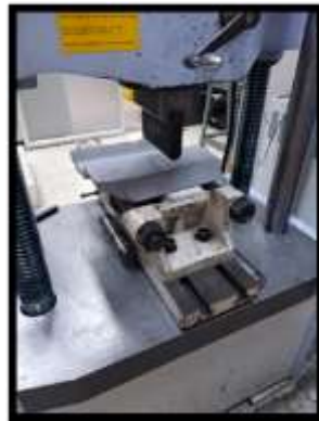
Ilustración 3: Ensayo de flexión en teja 2 Fuente: Propia Elaborado: Karen Lozano
